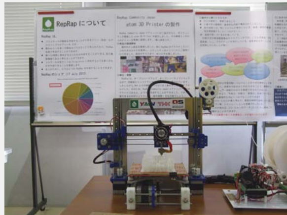
T H K 製品を使用した2号機3Dプリンター
