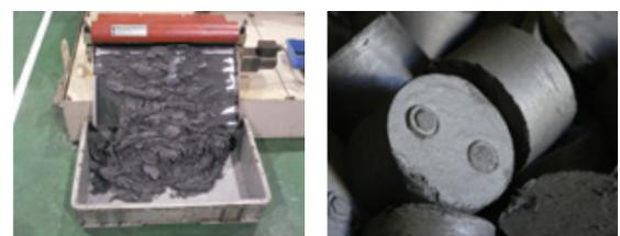
製造工程から出る研削スラッジ 圧縮固形化(ブリケット)
