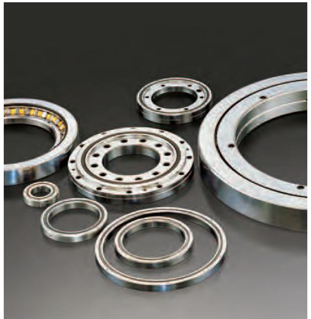
クロスローラーリングは内部に円筒ころが直交に配列されており、あらゆる方向からの荷重に耐えることができるローラーベアリングです。
