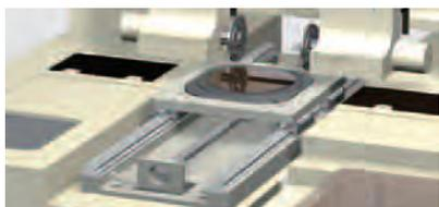
半導体製造装置（ダイシングソー）での使用例
