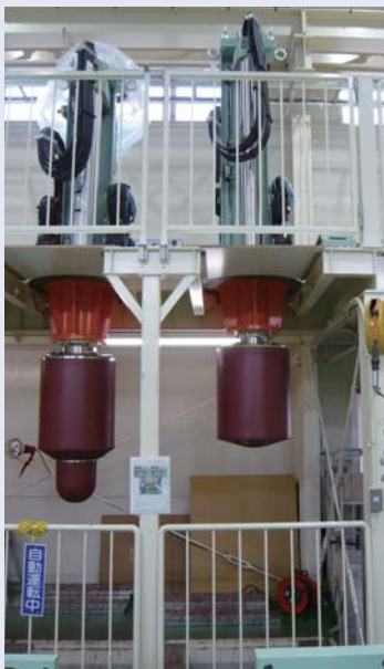
赤部分がセンサー 内部の昇降部分に転がり機構を採用
