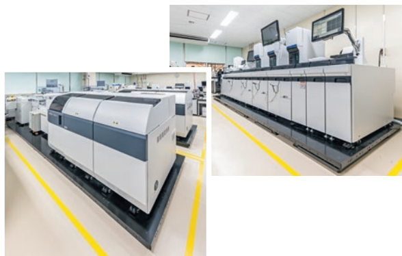
免震装置を設置した血液分析装置(右上)と生化学自動分析装置(左下)
