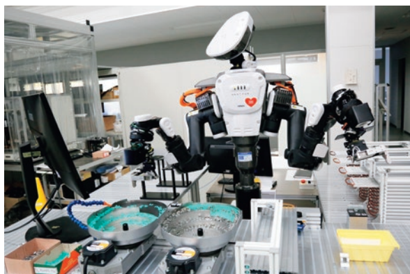
左右のハンドカメラで部品の位置関係を認識し作業するNEXTAGE®
