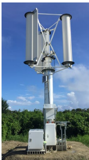
沖縄県南城市に設置した垂直軸型マグナス風力発電機
