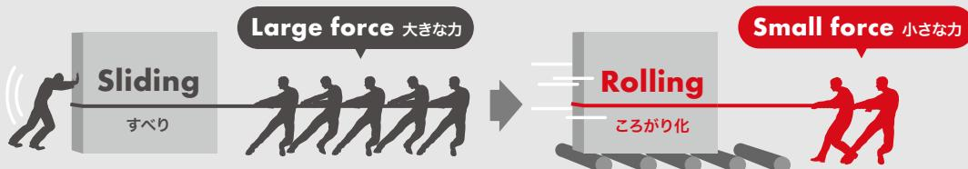
THKは、独創的な発想と独自の技術により、世界に先駆けて「直動システム」を開発しました。この「直動システム」とは、機械の直線運動部の「ころがり化」を実現したものです。回転運動部の「ころがり化」は、ベアリングにより100年以上も前に商品化されましたが、直線運動部の「ころがり化」は、難しいと言われ続けていました。その困難を世界で初めて打ち破ったのが、1972年の「直動システム」の開発でした。これにより高精度化、高速化、省力化、さらには効率の向上を生み出し、省エネを考慮した装置設計を可能にしました。
