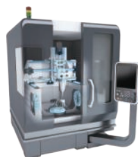
OMNIedgeを取り付けた3軸マシンングセンター (イメージイラスト)
