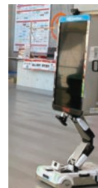
豊田スタジアムで実験中の自律移動型サイネージロボット
