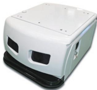
SIGNASは、ロボットに内蔵されているステレオカメラで、目印となるサインポストを認識しながら経路に沿って自律移動する搬送ロボットです。
