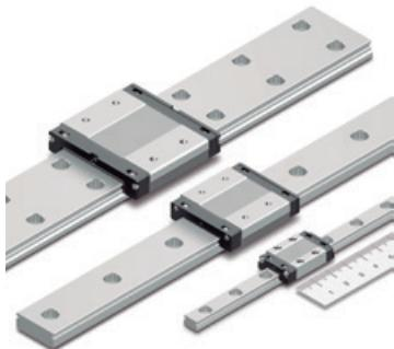
RSX形は、2条のボール転動面を有する4方向等荷重ボールタイプのミニチュアLMガイドです。既存タイプのボール循環部に改良を重ね、より滑らかな動きを実現しました。省スペースでの用途に適したコンパクト構造でありながら、モーメントが作用する箇所でも1軸使用ができます。
