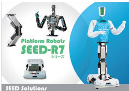
「SEED-R7シリーズ」は、THK独自のスマートアクチュエータを搭載したプラットフォームロボットです。ロボット構築に欠かせないメカトロニクス要素をユニット化することで、お客様の思い描くサービスロボットのアイデアを簡単に実現します。
