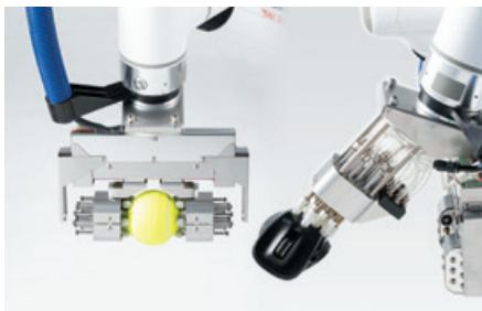
「TNH」は、掴むモノ（ワーク）の形状に合わせて変化する“ならい機構”を持ち、複雑な形状のワークでも安定して吸着・把持が可能な小型軽量の汎用ロボットハンドです。従来は、ワークの形状に応じ専用の爪やハンドの製作・交換が必要でしたが、本製品を使用することでその問題を解決し、初期費用削減・生産性向上によるコストダウンを実現します。
