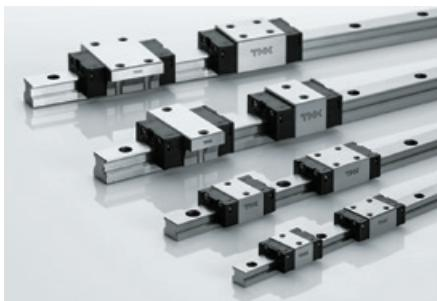
「HRG」は、転動体にローラーを使用することで、高剛性・長寿命化を実現した新たなラインナップです。4方向から掛かる荷重を許容できる構造のため、あらゆる姿勢（壁掛け・水平・逆さ・立て）での取付が可能となり、幅広い用途で使用できます。
