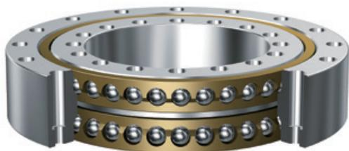
「BWH形」は、内外輪の間に保持器で複列にボールが配列された、THK史上最も高速性に優れた旋回軸受です。あらゆる方向の荷重を受けられ、クロスローラーリングと同等の高剛性と高い回転精度を有します。さらに、転動体をローラーからボールに変更した新構造の採用により、連続した高速回転でも発熱による温度上昇が大幅に抑制され、マシン性能の高機能化と生産性向上を図ることができます。
