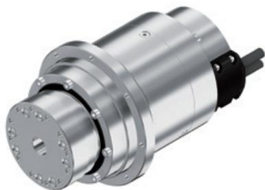
「RMR」は、剛性に優れたTHK製のクロスローラーリングを回転機構の主軸受とし、さらに減速機、モータ、エンコーダ、ブレーキなどの要素を一体化した、ロボットの関節機構に適したモジュールです。ロボットの関節部に必要なメカ要素がすべて備わっているため、そこにアーム部品や直動モジュールを自由自在に組み合わせることで、幅広い設備に適したお客様独自のロボット設計が可能となります。
