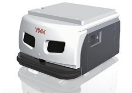
「SIGNAS」は内蔵カメラで目印となるサインポストを認識しながら自律移動する搬送ロボットです。独自の自律移動制御システムを搭載することによって、かつてない新しい誘導方式を実現します。プログラムの専門知識がなくても、サインポストの位置を変更することで簡単に走行場所を変えることができ、レイアウト変更工事の手間もかかりません。積載用途のほか、複数台の台車を後方に連結させたり、台車の下に入り込んで牽引するなどして、次工程へ製品を搬送することができます。既存機は牽引可能な重量が500kgでしたが、新型機は既存機の2倍の1トンに向上しました。
