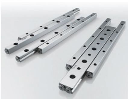
「ケージずれ防止機構付きクロスローラーガイド」は、精密ローラーを直交させて保持したケージを専用レールと組み合わせた構造で、有限ストロークの動きの軽い直動案内です。THK独自のラック&ピニオン機構を備えており、これによりケージずれの無い正確な動きを実現します。半導体製造装置をはじめ、電子部品の製造装置や光学測定器などに最適で、OA機器および周辺機器といった従来からあるニーズ以外にも需要が多く見込まれております。これまでは、取付間隔を自由に設計できる標準タイプがラインナップの中心でしたが、今回新たに取付の簡略化や装置のコンパクト化を実現するセンターレールタイプ\*を追加いたしました。既存のVR形に比べローラー数を増やし、基本定格荷重・剛性が大幅に向上し、かつ長寿命です。
