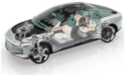
「LSR-05」は、THKが独自開発したEV向けアクチュエータ先進技術が多数搭載されています。デザインは株式会社SN DESIGN PLATFORM（代表取締役CEO：中村史郎）が担当し、両社が一体となって未来に向けた新しいモビリティの姿を具現化しました。THK独自開発の93kW（800V仕様）の変速磁束型インホイールモーターをリアに2基、フロントには220kW（800V仕様）のモーターを1基搭載した4輪ステア機構を採用しました。さらにアクティブサスペンション、MR流体減衰力可変ダンパー、電動ブレーキなどを搭載し、上質な乗り心地と優れた操縦安定性を実現しました。室内に採用したステルスシートスライドシステムはフロアの完全なフラット化を可能とし、高級感ある快適な空間を演出します。非接触給電システムも視野に入れ、「LSR-05」は未来に向けた新しいモビリティ用アクチュエータを搭載したコンセプトカーです。
