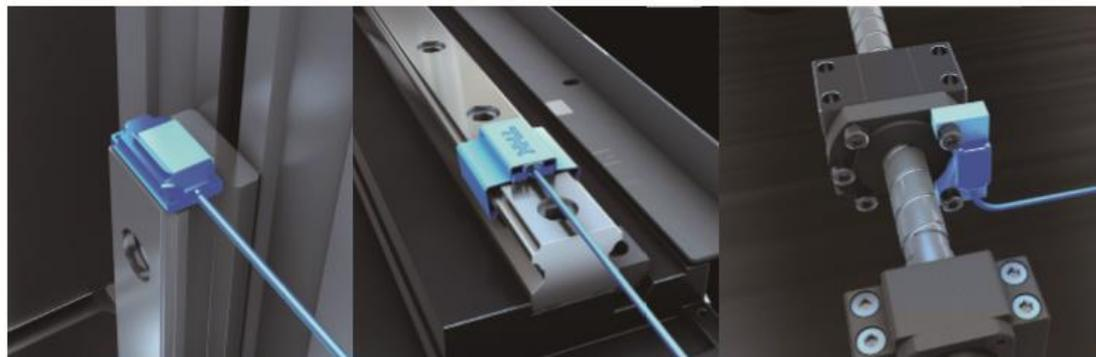
OMNIedge 是THK公司提供的IoT服务。通过对机械关键零部件的预测性维护，把异常状况可视化并告知用户。它可以使用户从选择传感器，确立算法，到构筑网络环境等耗时耗钱的高门槛业务中解放出来，在生产现场立即投入使用。
