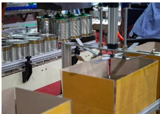
在装箱等多尘环境里，导轨仅用一年左右就需要更换。食品行业装箱流程里，必须避免导轨钢珠脱落导致的产品里混入异物。能否提早知晓异常情况呢？
