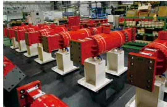
Viscous Damping System RDT **Viskosedämpfer RDT**
