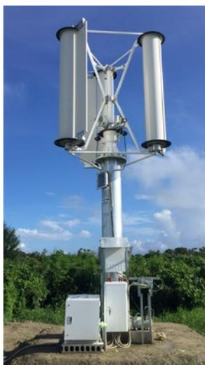
沖縄県南城市に設置した垂直軸型マグナス風力発電機
