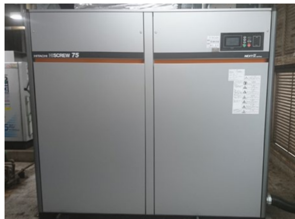
第3工場の更新したエアーコンプレッサー
