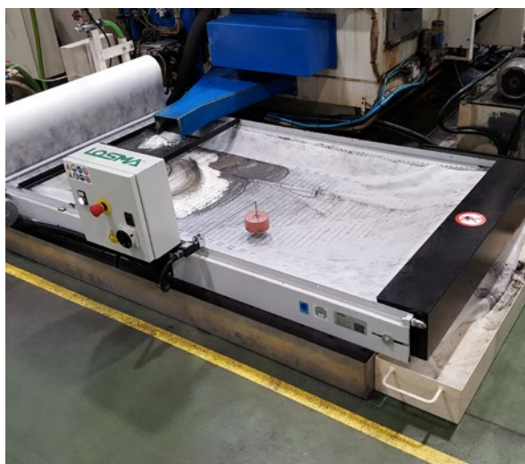
ペーパーの上に除去された鉄粉と砥粒が残るようになった
