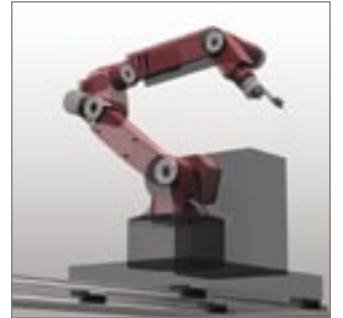
上記写真 ・産業用ロボット ・クロスローラーリング使用
