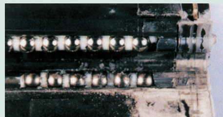
ボール転動面に多量の異物が流入している
